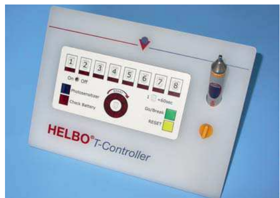
Abb. 4 Zeitnehmer zur Kontrolle sowohl der Einwirk- als auch der Belichtungszeit des Fotosensibilisators des HELBO-Systems.
